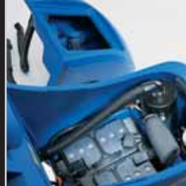
Aftagelig snavs vandstank, der kan rengøres separat på vaskeplads. Giver fuld adgang til batterielementerne.
