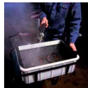
Rensekarret I dette kar kan de små komponenter så som bremse- og koblingsdele rengøres nemt.
